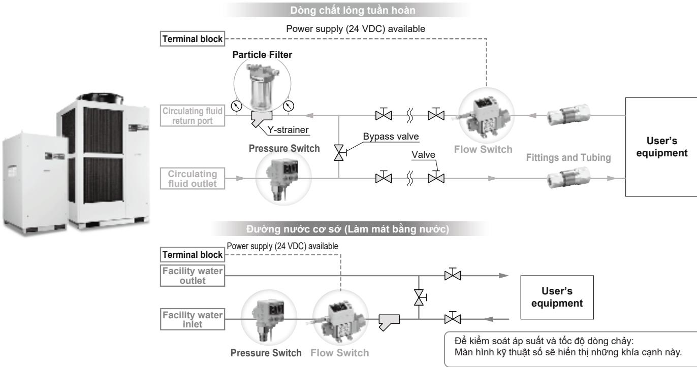
**Cảm biến lưu lượng:** Theo dõi tốc độ dòng chảy và nhiệt độ của chất lỏng tuần hoàn và nước cơ sở
